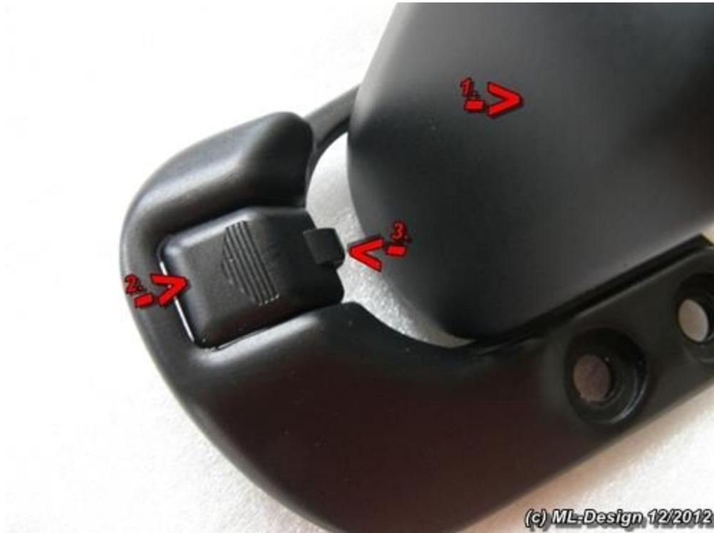
Im Laufe der Zeit wird es passieren, dass die Sicherungen (2.) der Verdeck Verschlüsse (1.) nicht mehr einrasten. Dieses geschieht entweder durch normale Abnutzung an der kleinen Nase (3.) die sich vor der Sicherung befindet, oder dadurch, dass beim Öffnen des Daches nicht zuerst auf die Sicherung gedrückt wird, sondern einfach an dem Verschluss gezogen wird.
