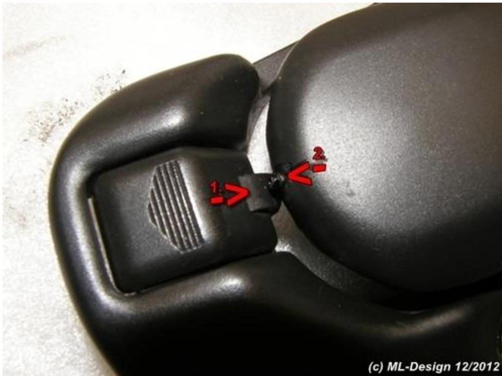
Die Schraube (2.) wurde mittig an der Kante in den Verschluss vorsichtig (da es sich um Gußmaterial handelt) eingesetzt und wie man auf dem Bild sehen kann, liegt sie bei geschlossenem Verschluss über der Nase (1.) der Sicherung. Damit ist gewährleistet, dass der Verdeck-Verschluss nicht mehr von selbst aufgehen kann.
