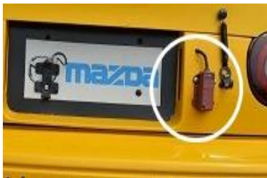
Transponder zur Datenübermittlung
